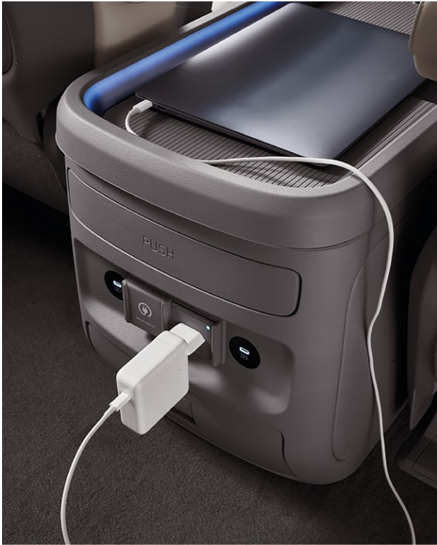
Υποδοχή Vehicle-to-Load (V2L) 230V στην κεντρική κονσόλα.
