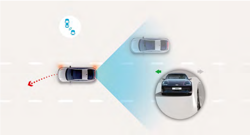
Blind Spot View Monitor (BVM). Προβολή Τυφλού Σημείου στον πίνακα οργάνων.
