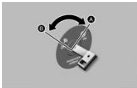
[A] Αερόσακος συνοδηγού ON [B] Αερόσακος συνοδηγού OFF
