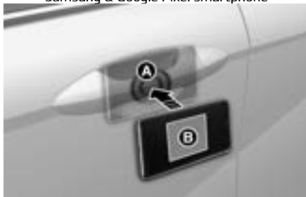
[A] Πλαίσιο ελέγχου ταυτότητας λαβής πόρτας [B] Κεραία NFC
