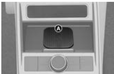
[A] Πλαίσιο ελέγχου ταυτότητας οχήματος (Ασύρματη βάση φόρτισης)
