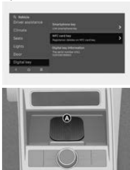
[A] Πλαίσιο ελέγχου ταυτότητας οχήματος (Ασύρματη βάση φόρτισης)
