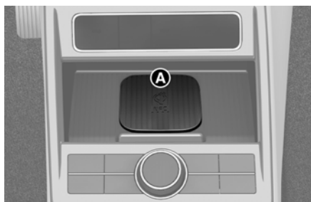
[A] Επιφάνεια ελέγχου ταυτότητας οχήματος (Ασύρματη βάση φόρτισης)
