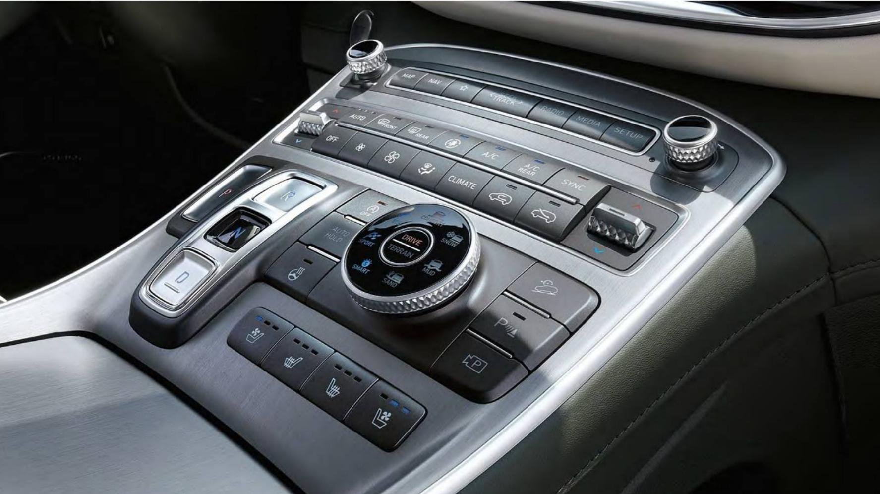
Κεντρική κονσόλα τύπου γέφυρας & αυτόματο κιβώτιο ταχυτήτων τεχνολογίας shift-by-wire.
