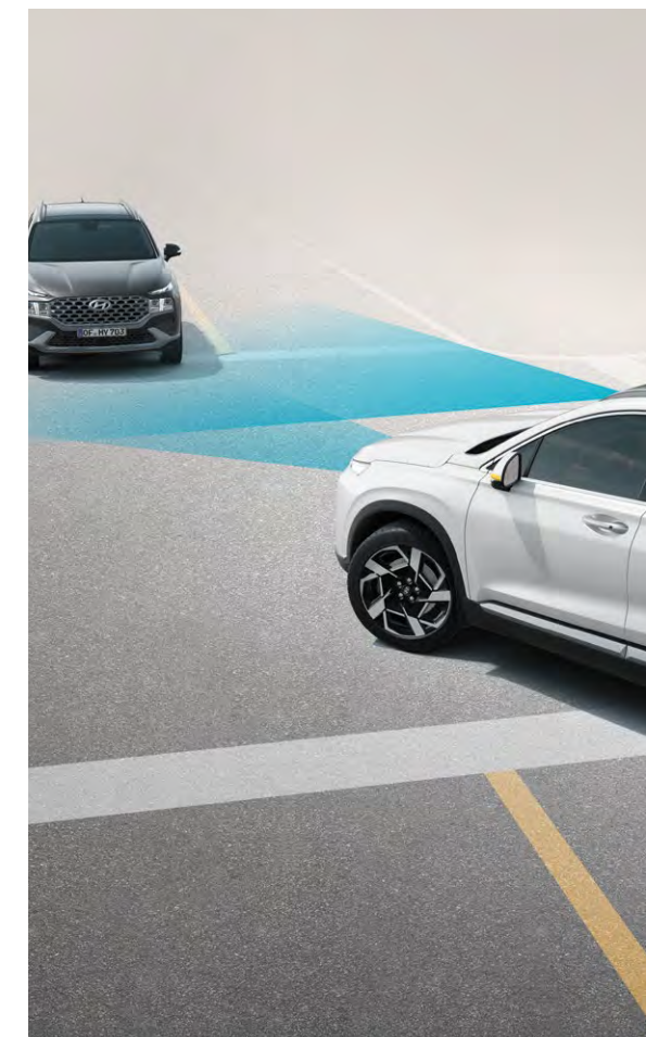
Forward Collision Avoidance Assist (FCA, Junction Turning) Το σύστημα FCA σας προειδοποιεί για αργά κινούμενα ή σταματημένα οχήματα καθώς και δικυκλιστές ή πεζούς στην πορεία σας και εφαρμόζει αυτόματα πλήρη ισχύ πέδησης εάν δεν αντιδράσετε έγκαιρα. Το ίδιο συμβαίνει και στην περίπτωση που ανιχνευτεί κίνδυνος σύγκρουσης με οχήματα που έρχονται από το αντίθετο ρεύμα κυκλοφορίας όταν στρίβετε αριστερά σε μια διασταύρωση.
