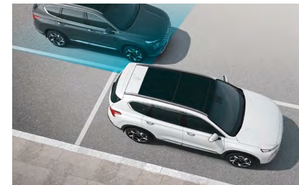
Safe Exit Assist (SEA) Αυτό το έξυπνο χαρακτηριστικό αποτρέπει ατυχήματα ανιχνεύοντας οχήματα που πλησιάζουν από πίσω και ενεργοποιεί προσωρινή αποφυγή ανοίγματος των πίσω θυρών, ώστε οι επιβάτες να μπορούν να εξέλθουν μόνον όταν κάτι τέτοιο μπορεί να γίνει με ασφάλεια.
