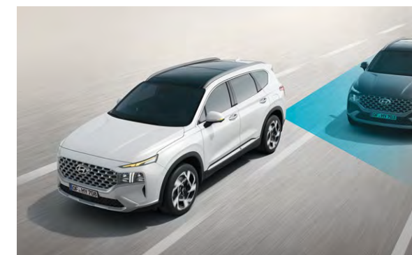
Blind-Spot Collision-Avoidance Assist (BCA) Χρησιμοποιώντας αισθητήρες ραντάρ στο κάτω τμήμα του πίσω προφυλακτήρα και μια εμπρόσθια κάμερα, το σύστημα αυτό σας προειδοποιεί για τυχόν κυκλοφορία στο τυφλό σημείο. Εάν ενεργοποιήσετε το φλας σε μια τέτοια περίπτωση, θα ακουστεί ένα προειδοποιητικό σήμα και το σύστημα θα φρενάρι ώστε να αποφευχθεί η σύγκρουση.
