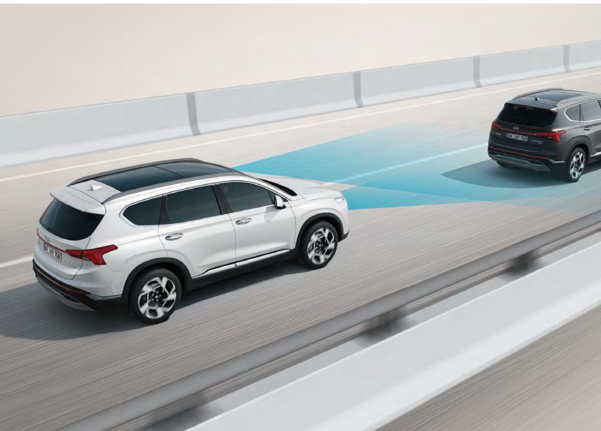
Highway Driving Assist (HDA) Διατηρεί το αυτοκίνητο στο κέντρο της λωρίδας και σε απόσταση ασφαλείας από το προπορευόμενο όχημα όταν είναι ενεργοποιημένο το Smart Cruise Control ή το Lane Following Assist.
