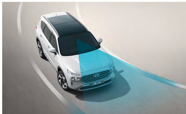
Lane Following Assist (LFA) Παραμονή στο κέντρο της λωρίδας για μεγαλύτερη ασφάλεια. Όταν το σύστημα είναι ενεργοποιημένο, διατηρεί το όχημα στο κέντρο της λωρίδας σε ταχύτητες μεταξύ 0 και 180 km/h στον αυτοκινητόδρομο ή σε δρόμους πόλεων.
