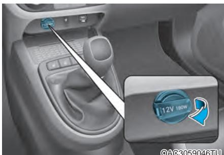
Η πρίζα είναι σχεδιασμένη για να παρέχει ρεύμα για κινητά τηλέφωνα και άλλες συσκευές σχεδιασμένες για να λειτουργούν με ηλεκτρικά συστήματα αυτοκινήτου.
