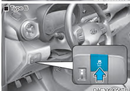
Το σύστημα Ηλεκτρονικού Προγράμματος Ευστάθειας (ESC) είναι σχεδιασμένο να σταθεροποιεί το αυτοκίνητο κατά τη διάρκεια ελιγμών στριψίματος.
