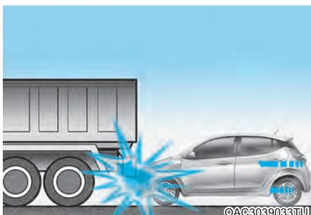
Λίγο πριν τη σύγκρουση, οι οδηγοί συχνά φρενάρουν έντονα. Τέτοια έντονα φρεναρίσματα χαμηλώνουν το εμπρός μέρος του αυτοκινήτου προκαλώντας το αυτοκίνητο να «σφηνωθεί» κάτω από ένα αυτο- κίνητο με μεγαλύτερη απόσταση από το έδαφος. Οι αερόσακοι μπορεί να μην ενεργοποιηθούν σε τέτοιες συνθήκες «σφηνώματος», γιατί οι δυνάμεις επιβράδυνσης που ανιχνεύονται από τους αισθητήρες μπορεί να υποκατασταθούν σημαντικά σε τέτοιες συνθήκες σύγκρουσης.
