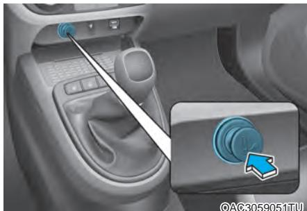
Για να χρησιμοποιήσετε τον αναπτήρα, το κλειδί πρέπει να βρίσκεται στη θέση ACC ή στη θέση ON.
