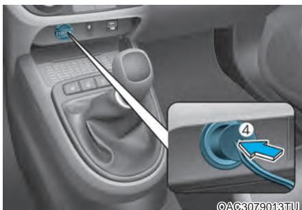
5. Τοποθετήστε το καλώδιο τροφοδοσίας του συμπιεστή (4), στην πρίζα του αυτοκινήτου.
