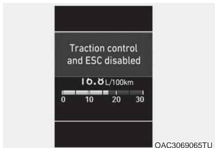
Πιέστε το πλήκτρο ESC OFF για περισσότερο από 3 δευτερόλεπτα. Η προειδοποιητική λυχνία ESC OFF και το/ή προειδοποιητικό μήνυμα “Traction control and ESC disabled” ανάβουν και ηχεί ένα προειδοποιητικό καμπανάκι. Σε αυτό το στάδιο, οι λειτουργίες ελέγχου κινητήρα (διαχείρηση κινητήρα) και φρένων (διαχείρηση φρένων) δεν λειτουργούν.
