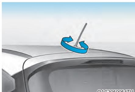
Η κεραία οροφής λαμβάνει DAB (αν έχει τοποθετηθεί), AM και FM εκμπεμπόμενα δεδομένα. Περιστρέψτε την αριστερόστροφα για να την αφαιρέσετε. Περιστρέψτε την δεξιόστροφα για να την επανατοποθετήσετε.
