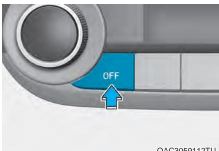
Πιέστε το πλήκτρο OFF για να θέσετε εκτός το σύστημα ελέγχου κλιματισμού. Ωστόσο, μπορείτε να συνέχιστε να χειρίζεστε τα πλήκτρα λειτουργίας και εισαγωγής αέρα για όσο διάστημα ο διακόπτης ανάφλεξης είναι στη θέση ON.
