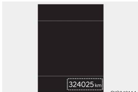
Ο χιλιομετρητής δείχνει τη συνολική διανυθείσα απόσταση του αυτοκινήτου και επίσης πρέπει να χρησιμοποιείται για τον προσδιορισμό του πότε θα πρέπει να πραγματοποιηθεί η περιοδική συντήρηση.
