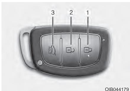
Το HYUNDAI σας χρησιμοποιεί ένα έξυπνο κλειδί, το οποίο μπορείτε να χρησιμοποιήσετε για να κλειδώσετε ή να ξεκλειδώσετε μια πόρτα (και τη πόρτα του χώρου αποσκευών) και ακόμα να εκκινήσετε τον κινητήρα.
