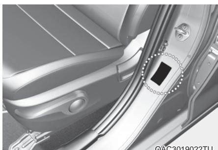
Η ετικέτα πιστοποίησης του αυτοκινήτου που είναι τοποθετημένη στη κεντρική κολόνα στη πλευρά του οδηγού (ή του συνοδηγού), δίνει τον αριθμό πλαισίου του αυτοκινήτου (VIN).
