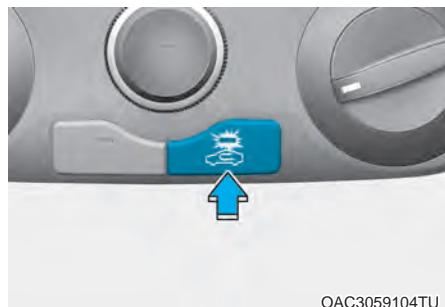
Το χειριστήριο εισαγωγής αέρα χρησιμοποιείται για την επιλογή εξωτερικού (φρέσκου) αέρα ή αέρα ανακύκλωσης (αέρας της καμπίνας).
