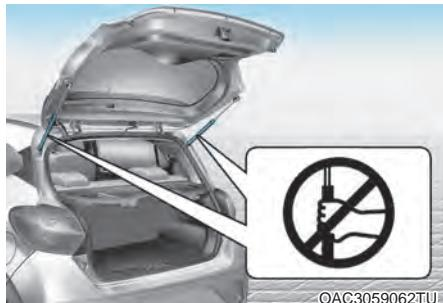
**Μην κρατάτε το εξάρτημα (ανυψωτήρας αερίου) που υποστηρίζει την πόρτα του χώρου αποσκευών. Λάβετε υπόψη ότι η παραμόρφωση του εξαρτήματος μπορεί να προκαλέσει ζημιά στο όχημα και κίνδυνο ατυχήματος.**
