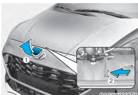
3. Πηγαίνετε στο εμπρός μέρος του αυτοκινήτου, ανυψώστε ελαφρά το καπό, τραβήξτε τη δευτερεύουσα κλειδαριά (1) εσωτερικά στο κέντρο του καπό και ανυψώστε το καπό (2).
