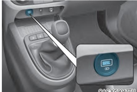
Ο φορτιστής USB βρίσκεται μέσα στο κουτί της κονσόλας ανάμεσα στο κάθισμα του οδηγού και το κάθισμα του συνοδηγού. Τοποθετήστε το φορτιστή USB στη θύρα USB και επαναφορτίστε ένα smart phone ή ένα τάμπλετ.
