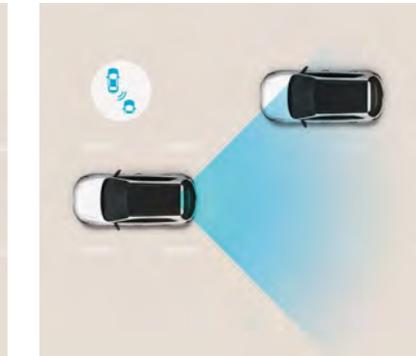
**Blind Spot Collision-avoidance Assist (BCA).** Με πληροφορίες από δύο αισθητήρες ραντάρ χαμηλά στον πίσω προφυλακτήρα, το σύστημα σας προειδοποιεί για τυχόν εμπόδιο στο τυφλό σημείο. Εάν ενεργοποιήσετε το φλας σε μία τέτοια περίπτωση, θα ακουστεί ένα προειδοποιητικό σήμα και το σύστημα θα φρενάρει για να αποφευχθεί η σύγκρουση (προαιρετικός εξοπλισμός).
